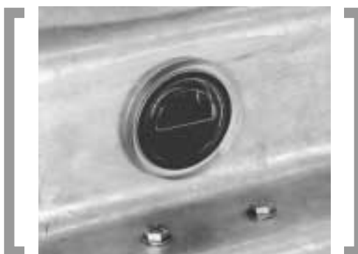
Fig. 2 - Indicador de nivel / Oil level indicator
